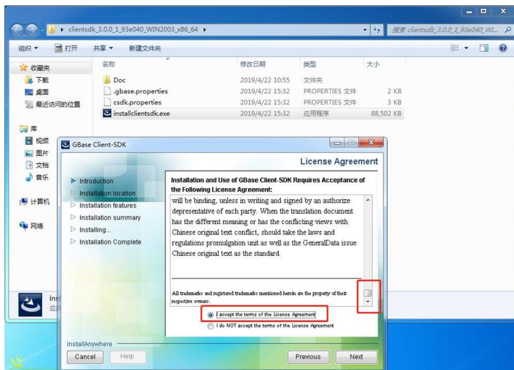
安装介绍协议页面，需要将滚动条拉到最下面，才可以点击接受协议的单选框。
