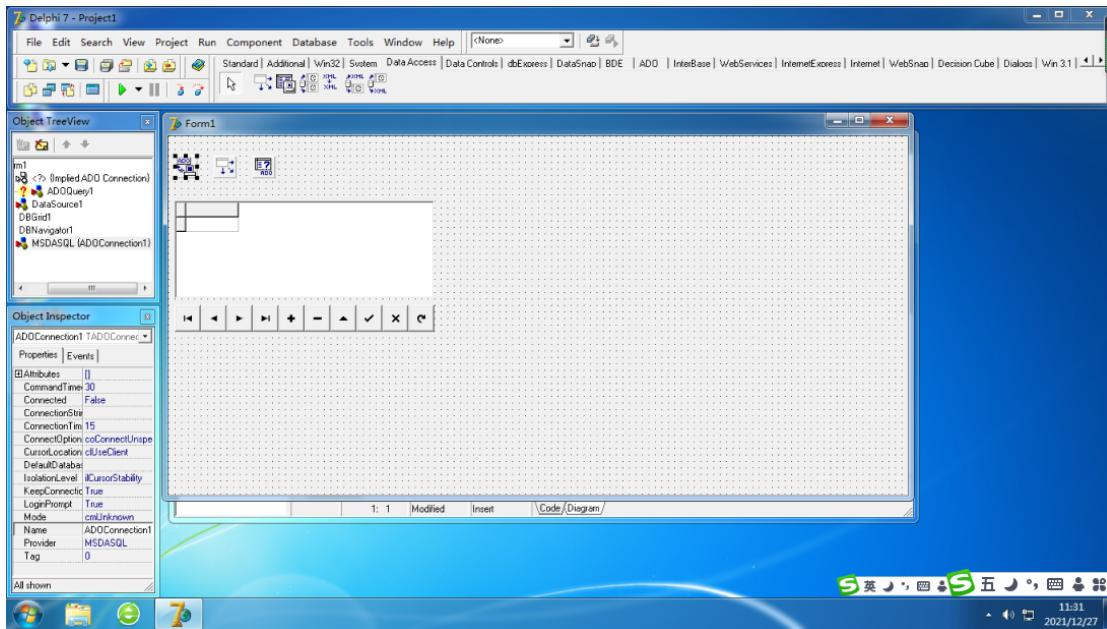
在 ADOConnection 控件 ADOConnection1 的 ConnectionString 中使用连接字符串 (Microsoft OLE EB Provider for ODBC Drivers)，选择 ODBC 中测试的连接，测试连接成功表示可以正常连接。
